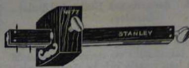
N:o 77. Amerikanskt Ritsmått »Stanley» Av polerat rosenträ med mässingsbeslag. Graderat i mm. Med delst ställskruven kan den ena stålspetsen inställas på olika avstånd från den andra. Längd 16½ cm.
